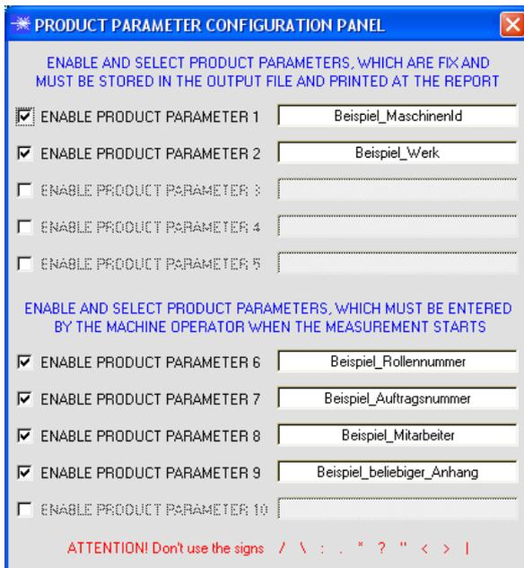
Es stehen 5 Parameter zur Verfügung, die individuell eingegeben werden können. Die Daten sind fix und werden beim Abspeichern, sofern „Enabled“, im File abgelegt bzw. mit ausgedruckt.
