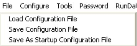
Mit Hilfe des Menü Buttons „**File**“ können bestimmte Konfigurationsdaten, welche unter „**Configure**“ eingestellt werden, in ein File gespeichert bzw. von einem File gelesen werden.
