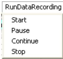
In diesem Menü Punkt wird die Datenaufzeichnung „**Start**“ gestartet und mit „**Stop**“ beendet. Zusätzlich kann man die Datenaufzeichnung mit „**Pause**“ unterbrechen und mit „**Continue**“ wieder aufnehmen.
