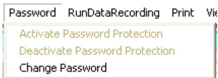
Die Bereiche „**File**“, „**Configure**“ und „**Tools**“ können mit einem Passwort geschützt werden. Der Passwortschutz kann ein- und ausgeschaltet werden. Das Default Passwort lautet: 0000000000 (in Worten: 10 Mal die Null). Das Passwort kann individuell geändert werden.
